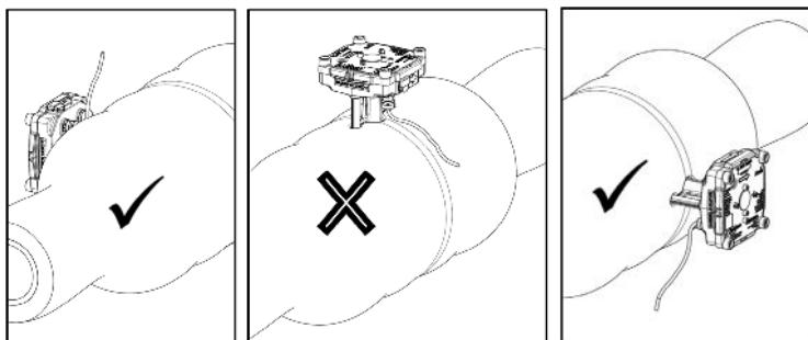
Рис. 2. Положение установки расходомера с теплоизоляцией при 130°- 150°C
