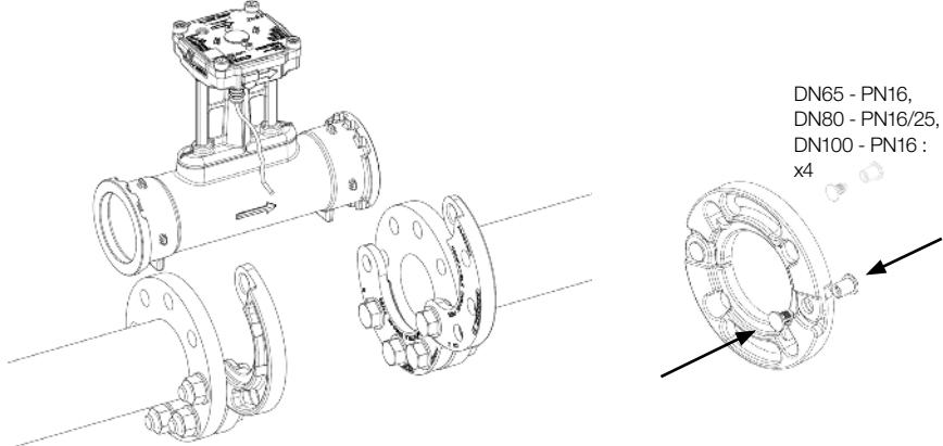
Рис. 4. Установка расходомера AXONIC с мобильными фланцами
