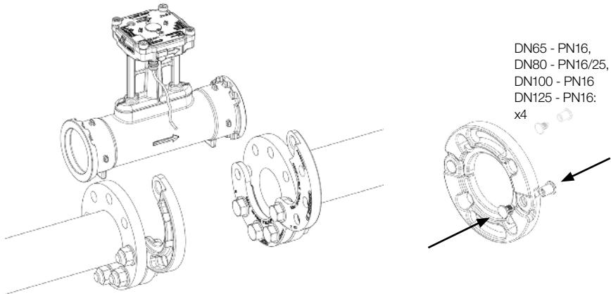
Slika 4: vgradnja merilnika pretoka AXONIC z mobilnima prirobnicama
