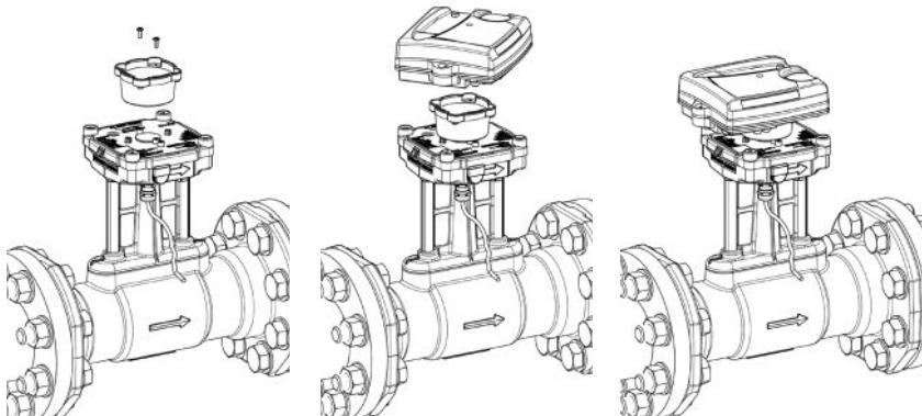
Obr.5: Montáž kalorimetru CF51 / CF55 na průtokoměr
