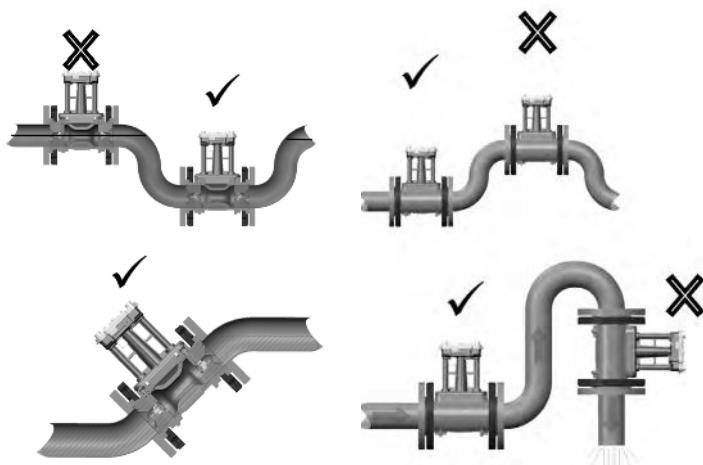
Рис. 3. Радиодемер всегда должен быть полностью заполнен водой
