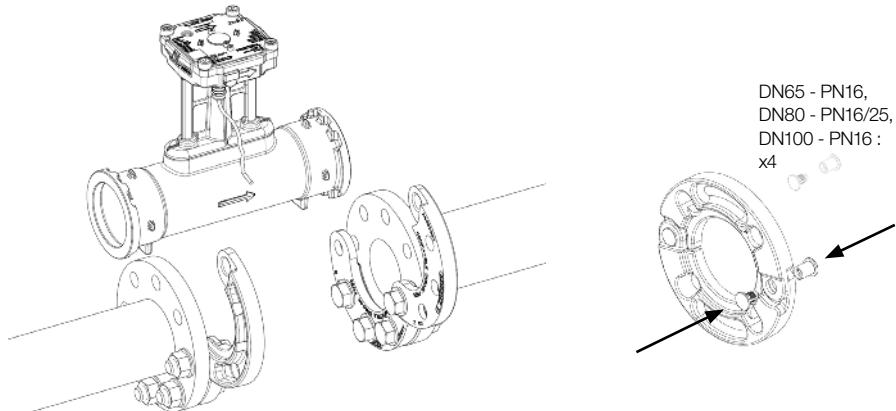
Fig N°4 : Installation AXONIC avec brides mobiles
