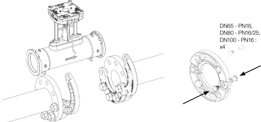
图4: 连接安装Axonic和专用活动法兰
