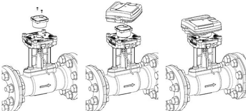
Рис. 5. Установка вычислителя Itron CF51/CF55 на AXONIC
