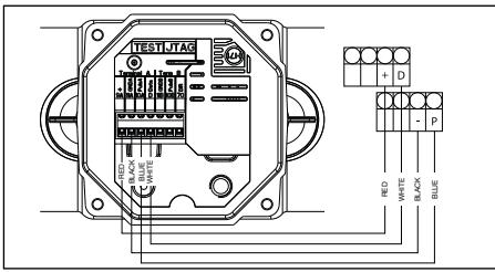
Připojení průtokoměru ke kalorimetru CF800
