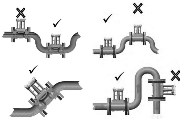
图3: 确保流量计总是保持满水状态
