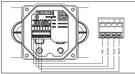
Připojení průtokoměru ke kalorimetru CF51-CF55
