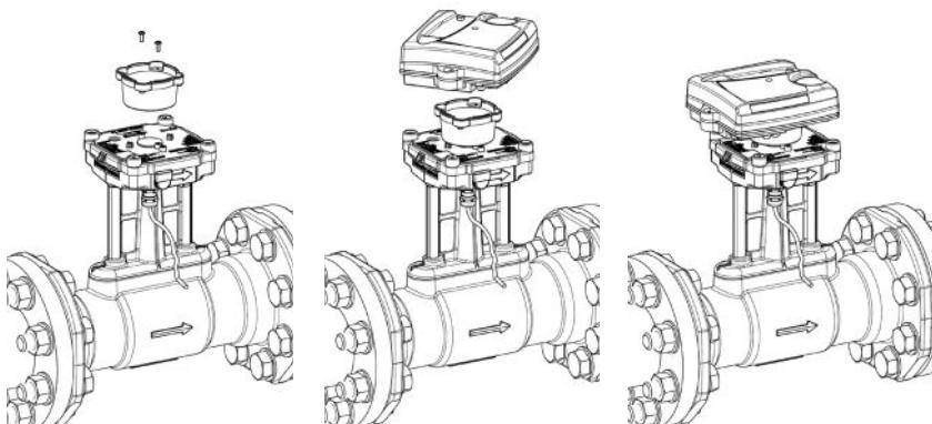
Fig N°5 : Montage avec intégrateur CF51/CF55 sur AXONIC
